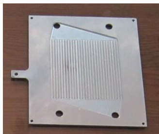
نمونه طراحی شده و نمونه واقعی ساخته شده صفحات اتصال دهنده استک
